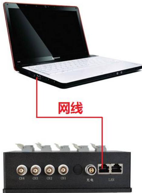
TST5925EV 单台有线连接系统框图
