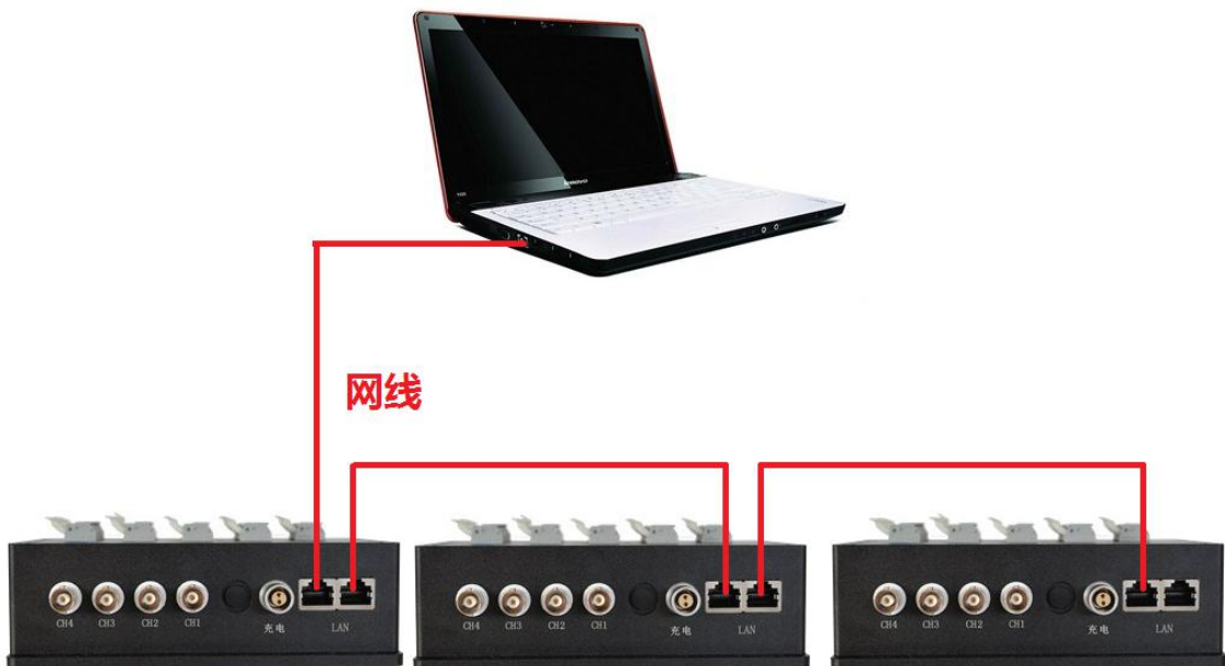
TST5925EV 多台有线连接系统框图
