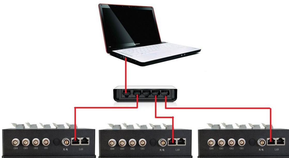
TST5925EV 多台有线 HUB 连接系统框图
