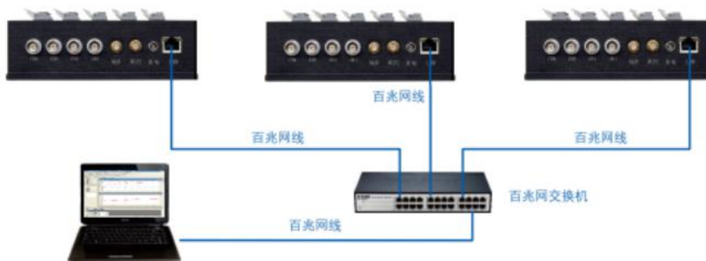
TST5925EV 多台有线连接系统框图
